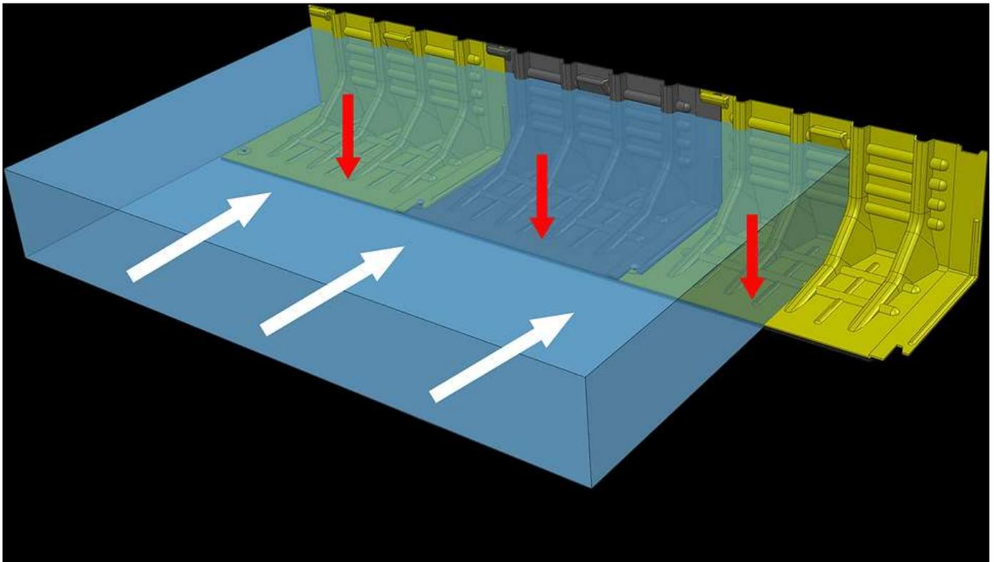
Je höher das Wasser steigt, desto stärker wird die Schutzwand gegen den Untergrund gepresst. Da der Druck des Wassers genutzt wird, haben die Module wenig Eigengewicht. Die Module wiegen **nur je 4 kg**. Der Schutzdamm lässt sich einfach und schnell aufbauen. Eine Person kann in weniger als einer Stunde eine 100 m lange Sperre errichten. Das Beaver Flood Fence ist ein sehr familienfreundlicher Hochwasserschutz. Es sind keine Feuerwehrgrundkenntnisse notwendig.
