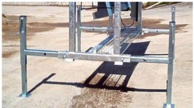
Abbildung 2: Die Maschine ist mit ausfahrbaren Stützen ausgestattet.
