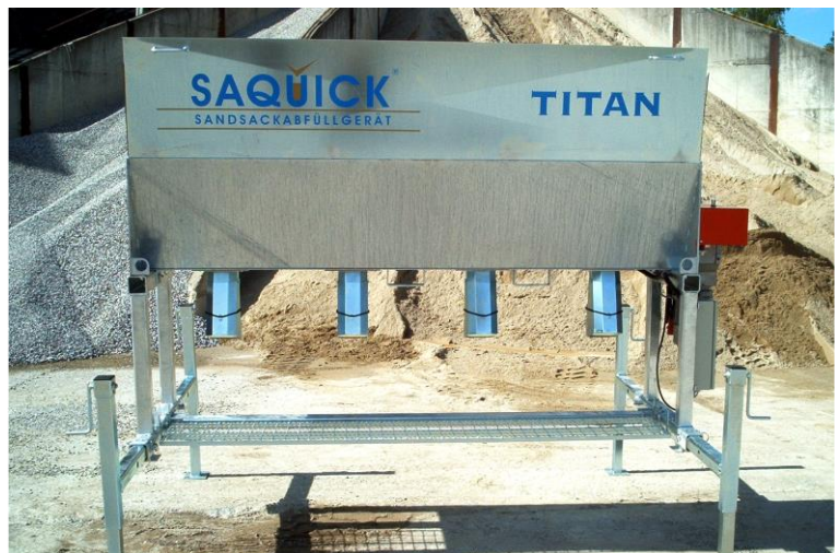
Abbildung 1: An der Unterseite des Sandtrogs sind die Kranösen sowie die Staplerschuhe für den Transport erkennbar.
