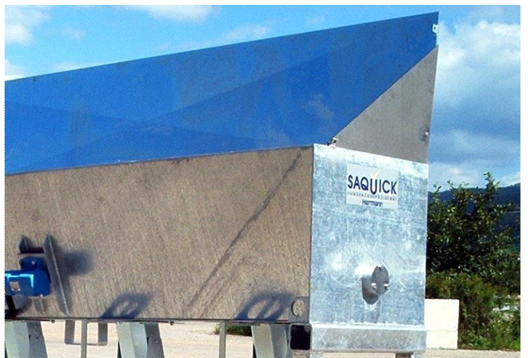
Abbildung 4: Das Schüttblech (2) schützt den Arbeitsplatz vor herabfallendem Sand.
